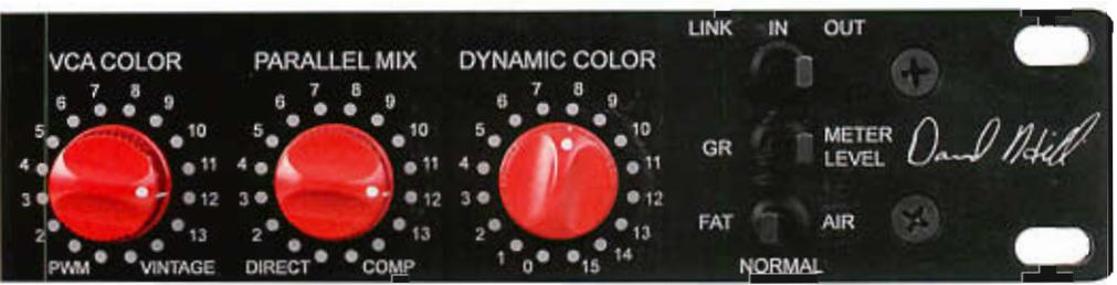
gungsfaktor, wenn man eine schnelle Drehbewegung vollführt. Mit dem zusätzlich vorhandenen Gain-Regler lässt sich die Aufholverstärkung in 0.5 dB Schritten bis zu maximal 11.5 dB einstellen. Die Werte für die Ansprechzeit lassen sich in einem Bereich von 50 Mikrosekunden bis zu 400 Millisekunden variieren, die Rückstellzeit stellt eine Regelskala von 50 Millisekunden bis 5 Sekunden zur Verfügung. Damit wäre der ‚normale‘ Bedienbereich des Titan auch schon vollständig behandelt.
